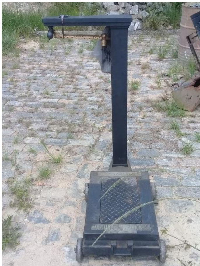
Figura 3. Balança mecânica de até 200kg, para sacaria, com contrapeso para medição dos RSU.
